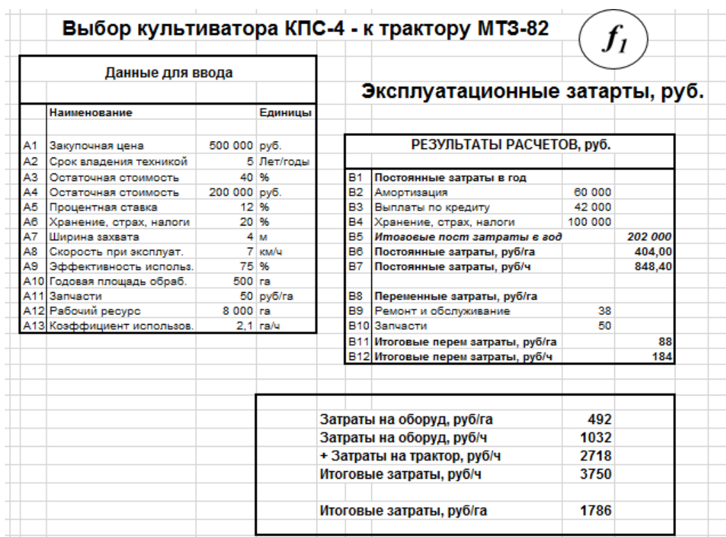
Рисунок 4 – Расчет f_1 (культиватор КПС-4 к трактору МТЗ-82)
