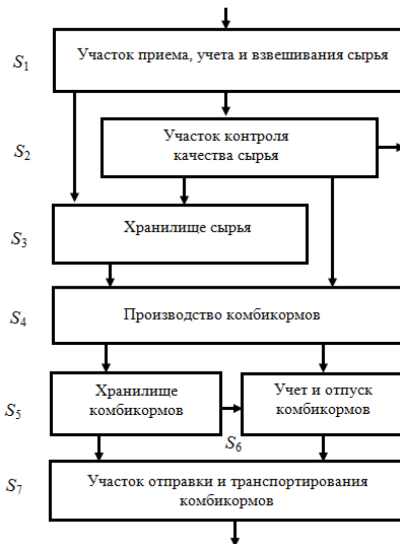
Рис. 1. Схема материальных потоков при производстве комбикормов
