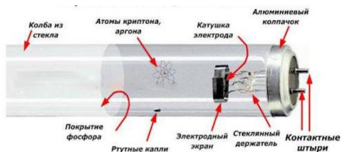
Рисунок 1-Устройство люминесцентной лампы
