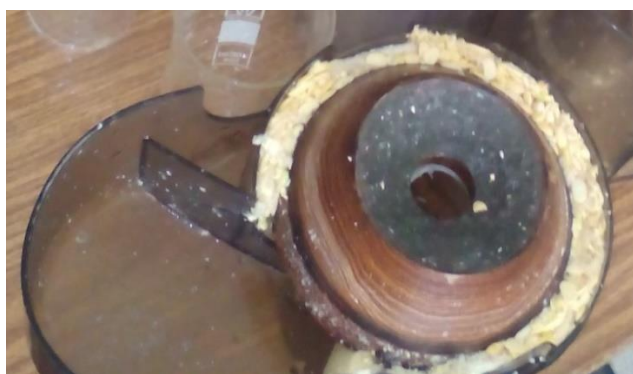
Рисунок 3 – Закрепленный истирающий диск
