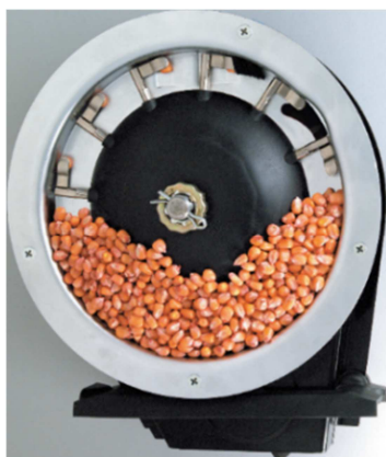
Рисунок 7 – Механический высевающий аппарат с пальчиковым механиз- мом пунктирной пропашной сеялки Kinze 3600
