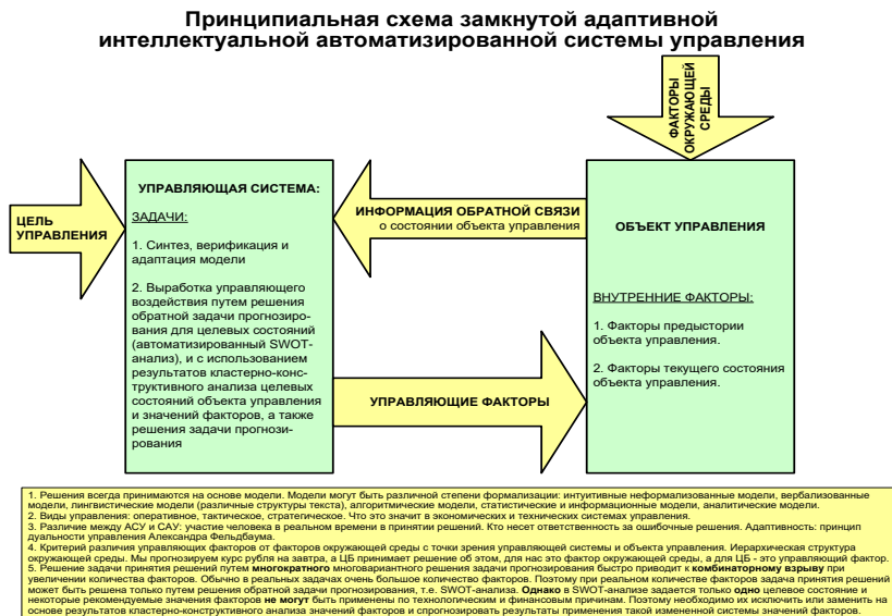
Рисунок 14. Принципиальная схема интеллектуальной адаптивной системы управления на основе АСК-анализа и системы «Эйдос»
