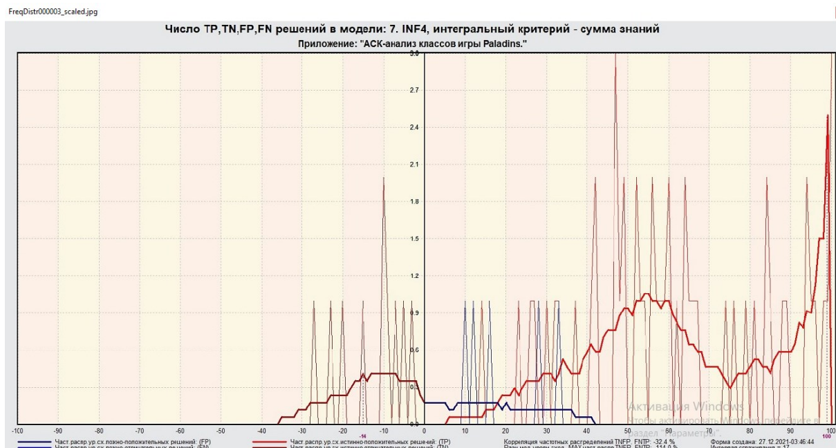
Рисунок 13. Частотные распределения числа истинных и ложных положительных и отрицательных решений и их разности в СК-модели Inf4
