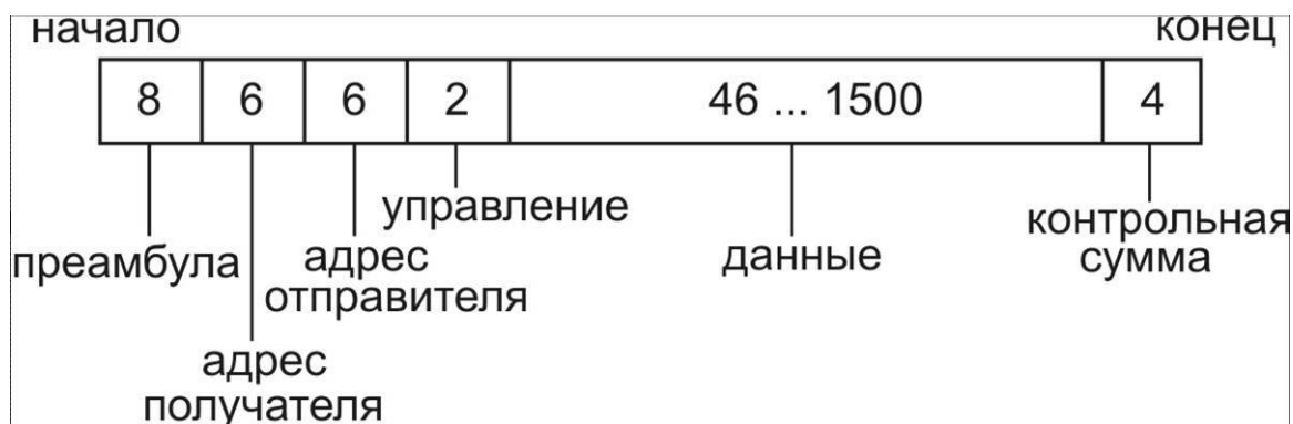
Рис. 53. Формат пакета Ethernet
