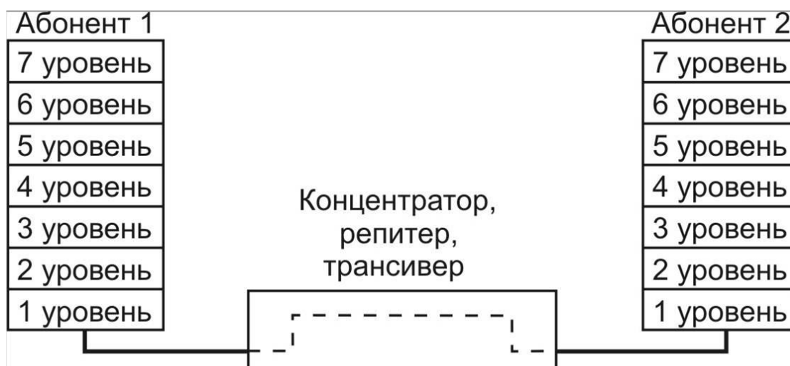
Рис. 34. Функции репитеров, трансиверов и концентраторов
